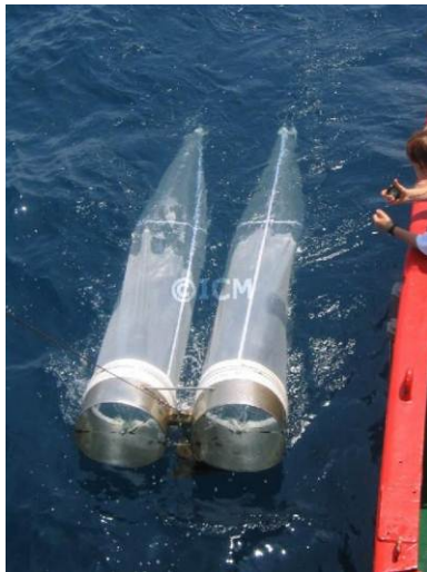
Fig. 3.2.1.a Bongo net (Photo I. Palomera)
