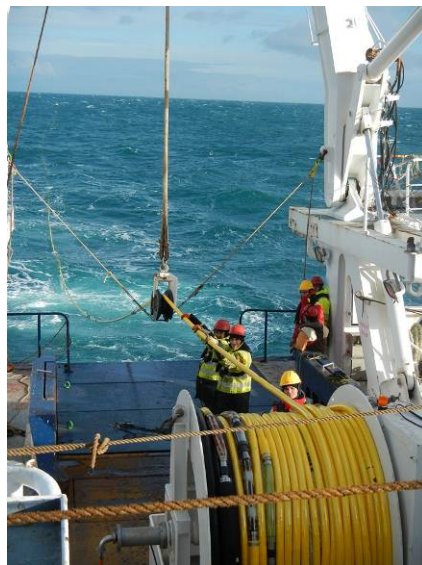
Fig. 3.11.1.a – Streamer. (Photo Ifremer)
