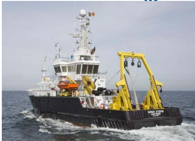
Fig. 4.2.3.2.g - RV Simon Stevin Aft frame. (Photo VLIZ)
